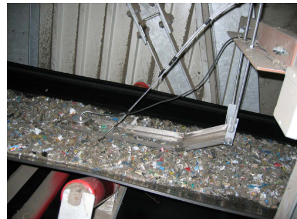
Sensor auf Band mit Gleitschuhschlitten
