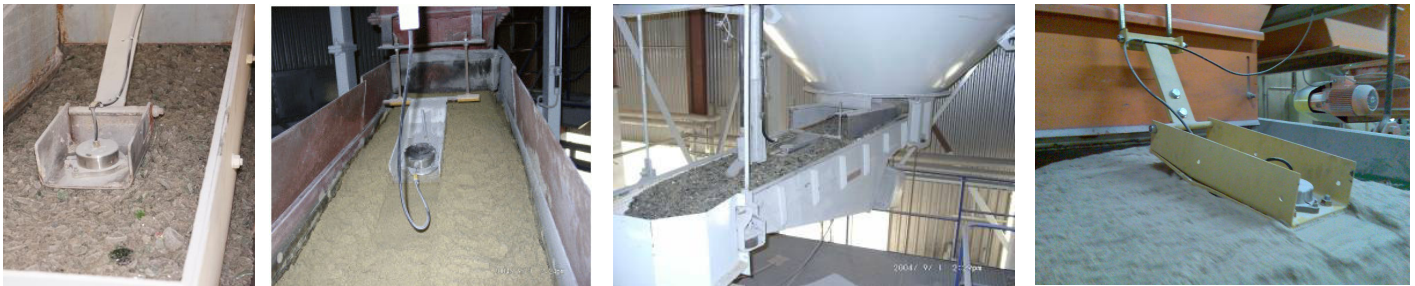
Sensoren auf Band mit Gleitschuhschlitten
