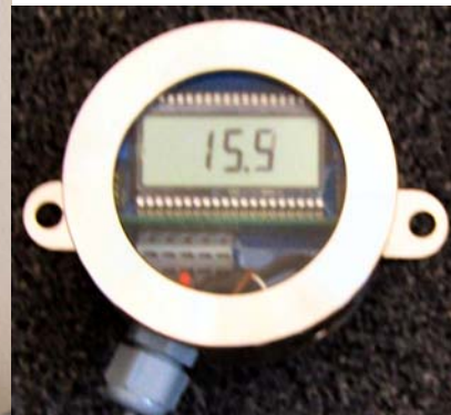
Abbildung 10 lokale Edelstahl Feuchteanzeige
